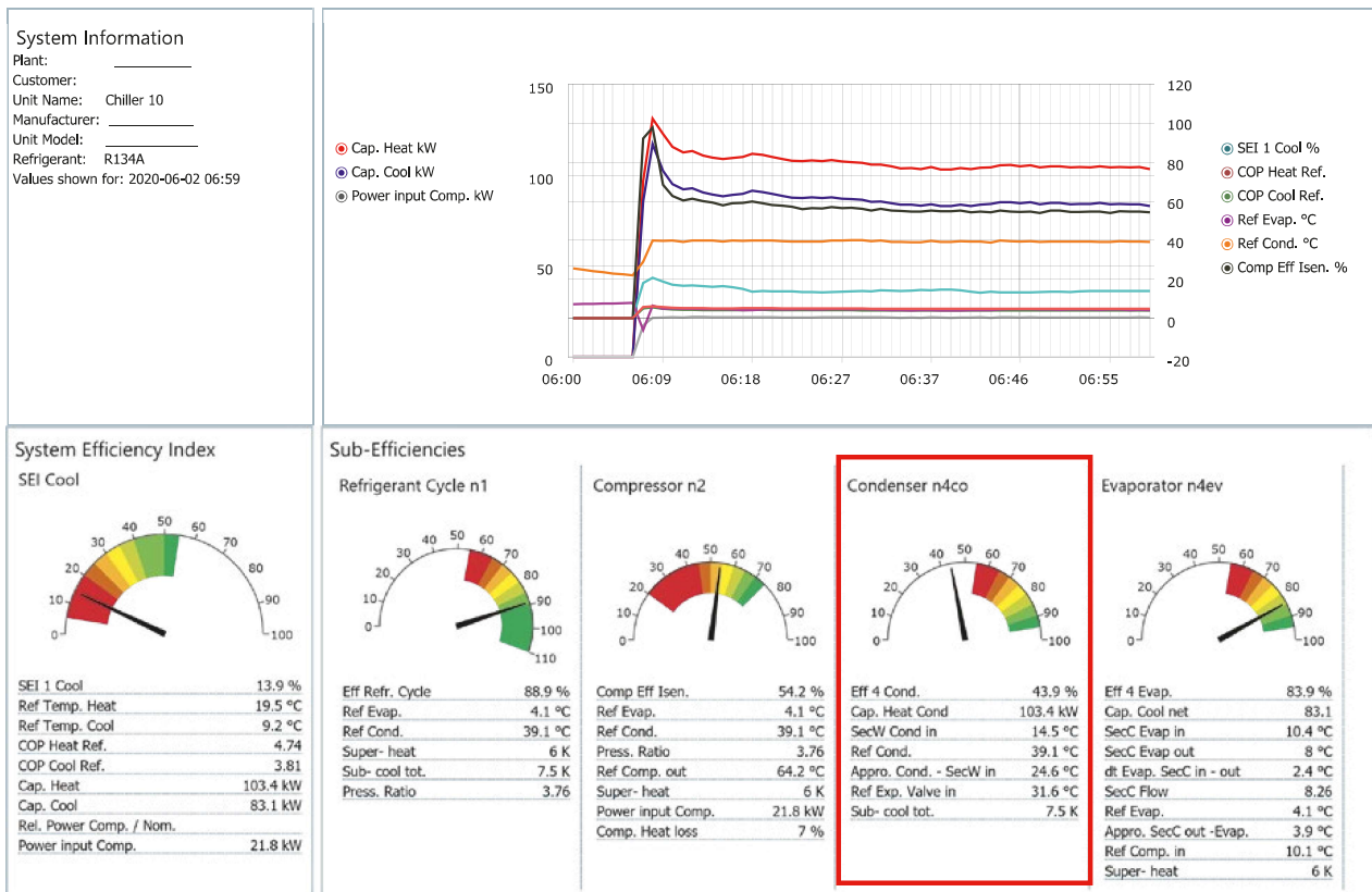
Bild X-10: Dashboard zeigt nicht nur die schlechte Gesamteffizienz des Kaltwassersatzes, sondern auch die Effizienz der Hauptkomponenten an (Quelle: ClimaCheck online)
