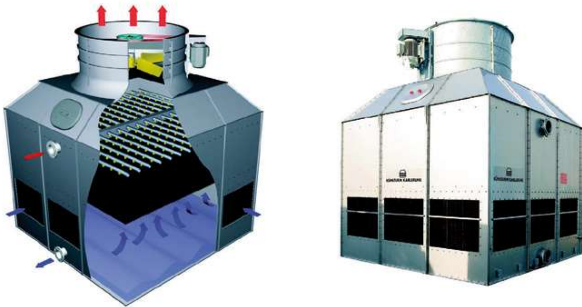
Bild III-27: Saugbelüfteter Verdunstungskühlturm für offenen Kreislauf mit Axialventilator mit Gegenstrom Luft/Wasserführung (KTK Kühlturm Karlsruhe GmbH)
